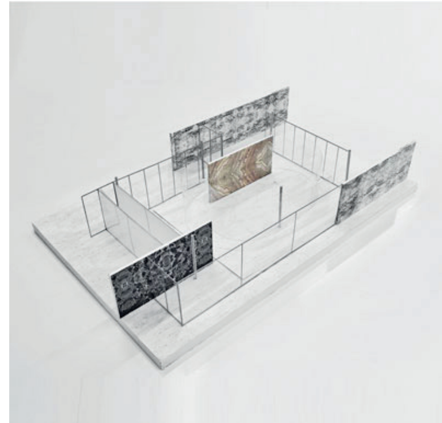
รูปที่ 3 แสดงผนังที่ถูกวางอย่างอิสระมีการแยกโครงสร้างออกจากผนังอย่างสิ้นเชิง
